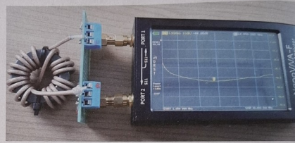
Bild 1: Messung der Durchgangsdämpfung (S21) des 1:1-Baluns im Bereich 1...30 MHz mit dem NanoVNA
