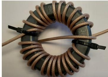
Mit dem *NanoVNA* messe ich die erste Parallelresonanz bereits bei  $7,37\text{MHz}$ , die entsprechende Durchgangsdämpfung beträgt  $48\text{dB}$ .
