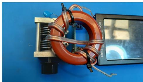
Mittels Transmissionsmessung (S21 Gain) wird mit dem Drehko Resonanz auf 14,1MHz eingestellt und dazu die Durchgangsdämpfung (33,6dB) abgelesen. Nach Eingabe dieser Werte in den Spulenrechner zeigt dieser die Güte QL = 72,64 an:
